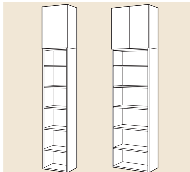
図は、天袋とオープンラックを組合わせたものです。棚部の積載重量は棚幅10cmあたり2kgまでです。
